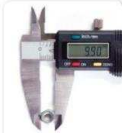
الشكل 11 يستخدم المقياس العكسي الرقمي للتحقق من حجم صامولة حتى جزء من المئة من المليمتر (0.01 mm). إن المهارة المطلوبة لتعديل وضع الجزء في المقياس العكسي بصورة صحيحة، سيحصل الميكانيكون أصحاب الخبرة على قراءات أكثر دقة ودقة من الميكانيكين غير الخبراء.
