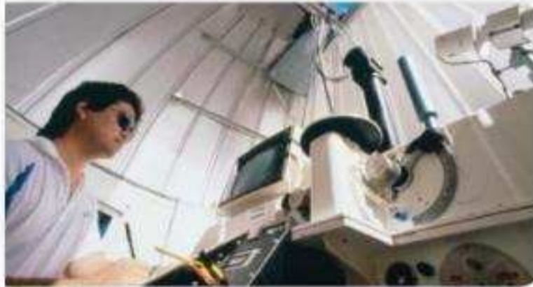
الشكل 15 يستخدم مطياف الأشعة فوق البنفسجية - المرئية (UV-Vis) هذا لقياس غازات طبقة الأوزون وغيرها من الغازات في طبقة الستراتوسفير خلال أشهر الشتاء الباردة في القارة القطبية الجنوبية.
